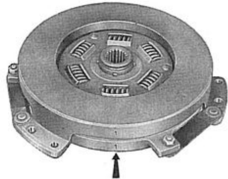
Abb. 56 - Vollständige Kupplung seitlich auf den Deckel gesehen.
