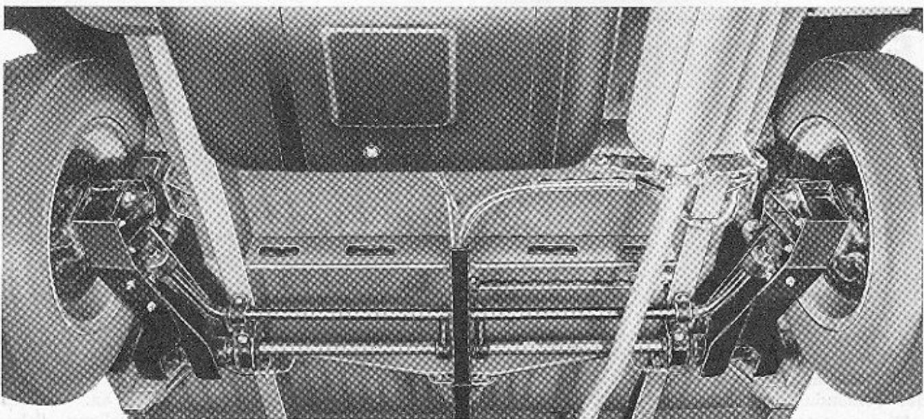
Abb. 15 - Hinterradaufhängung von unten gesehen.
