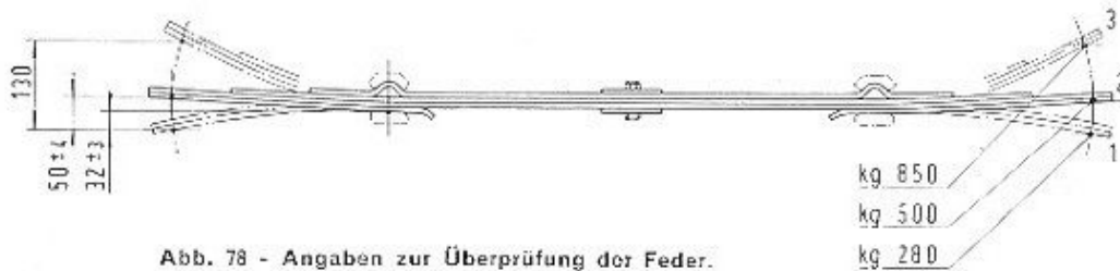
Abb. 78 - Angaben zur Überprüfung der Feder.
